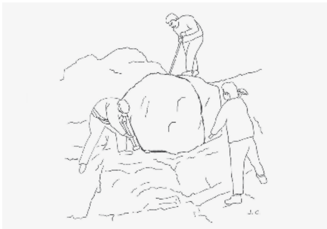
..... Harginak palanka eta ziriekkin lanean. Canteros trabajando con palancas y cuñas.
